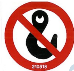
Не использовать для подъема краном (поз. 25)
