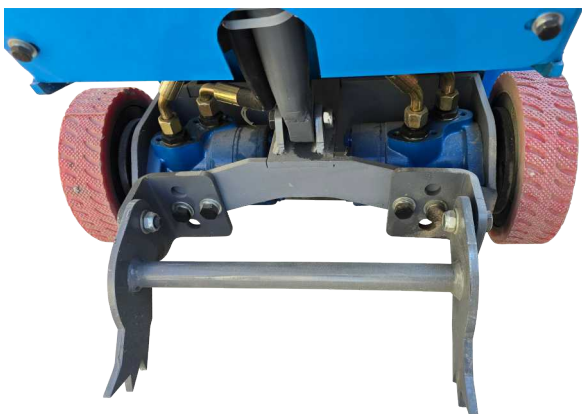
Стопорное устройство для безопасности оператора
