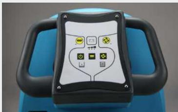
Многофункциональная панель управления с устройством распознавания идентификационных карт операторов
